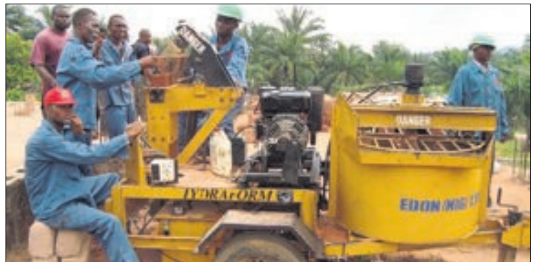
Ausbildungsgang an der Hydraform Clay-Block Machine.
